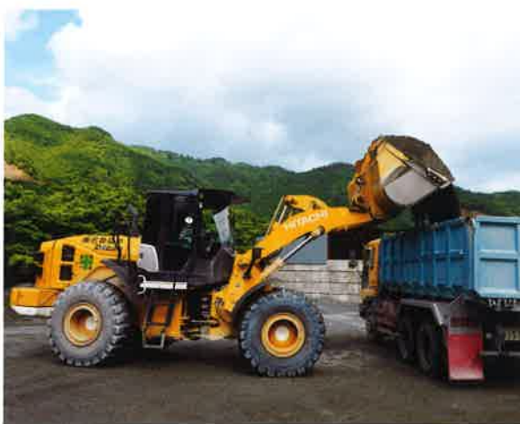
多いときで約100台のダンプがヤードに来訪。2台のカワサキ機とともに、1日10時間の稼働で砕石・砕砂を積み込む ZW220-5B。
