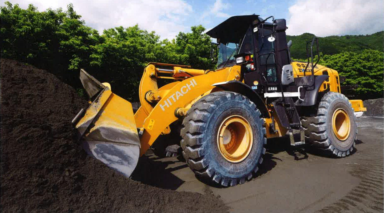
中央砕石株式会社に初めて導入された日立建機のホイールローダ ZW220-5B (装着しているバケットは3.4m 3 、本体塗装は使い慣れたカワサキ色)。
